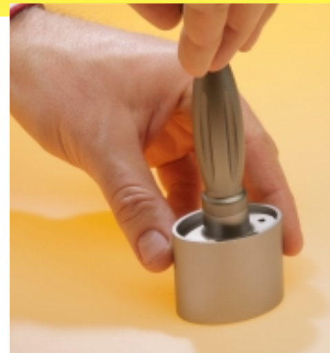
Verdichten: Die lose eingefüllten Zutaten durch sanften Druck mit dem Stempel samt der aufgeschraubten passenden Eindrückscheibe vorsichtig verdichten
